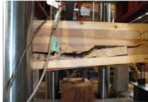
b) 層間剥離を伴う曲げ破壊形態
