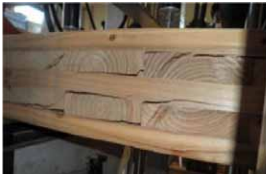
a) 層間剥離とローリングシアー破壊
