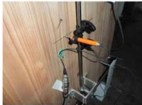
d)矢高計測用変位計設置状況
