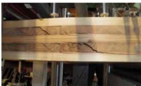
c) 部材横断型せん断破壊
