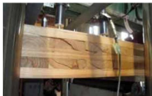
d) 部材横断型せん断破壊
