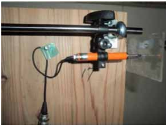
c) 短辺方向伸縮測定用変位計設置状況
