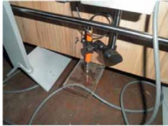
b)長手方向伸縮測定用変位計設置状況
