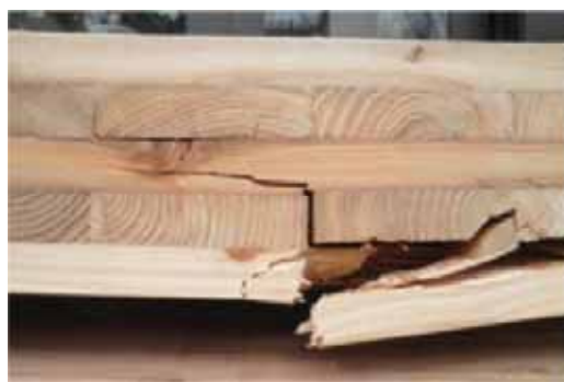
a) 繊維破断型曲げ破壊形態
