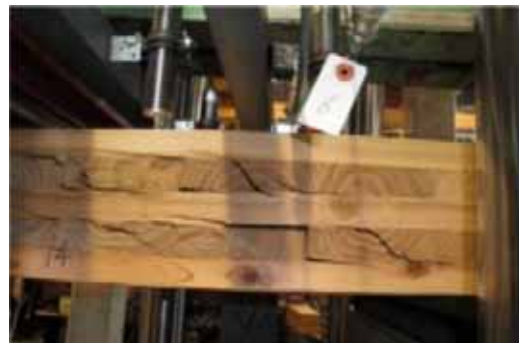
b) 部材横断型せん断破壊
