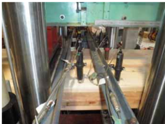
b) 変位計設置状況詳細
